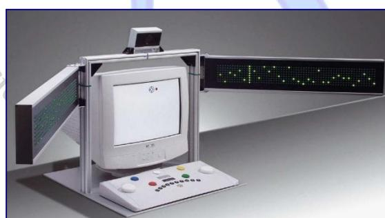
شكل (1) يوضح الجهاز الرئيس لاختبار إدراك المحيط.
